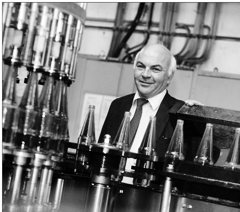
Zwischen Tradition und Moderne: Josef Möller jun. führt den Betrieb, der zu den Top 25 der deutschen Fruchtsafthersteller gehört, in dritter Generation. Die Abfüllanlage schafft gut 50 000 Flaschen am Tag. Zuvor wird der Saft 30 Sekunden lang auf 85 Grad erhitzt und dann langsam abgekühlt. Anschließend ist der Apfelsaft – ohne chemische Konservierungsstoffe – zwei Jahre haltbar. Auf dem Firmengelände stapeln sich seit jeher im Herbst die Äpfel. Die ehemalige Fahrzeugflotte lässt Oldtimer-Freunde schwärmen. —FOTOS: GUTZEIT/PRIVAT
